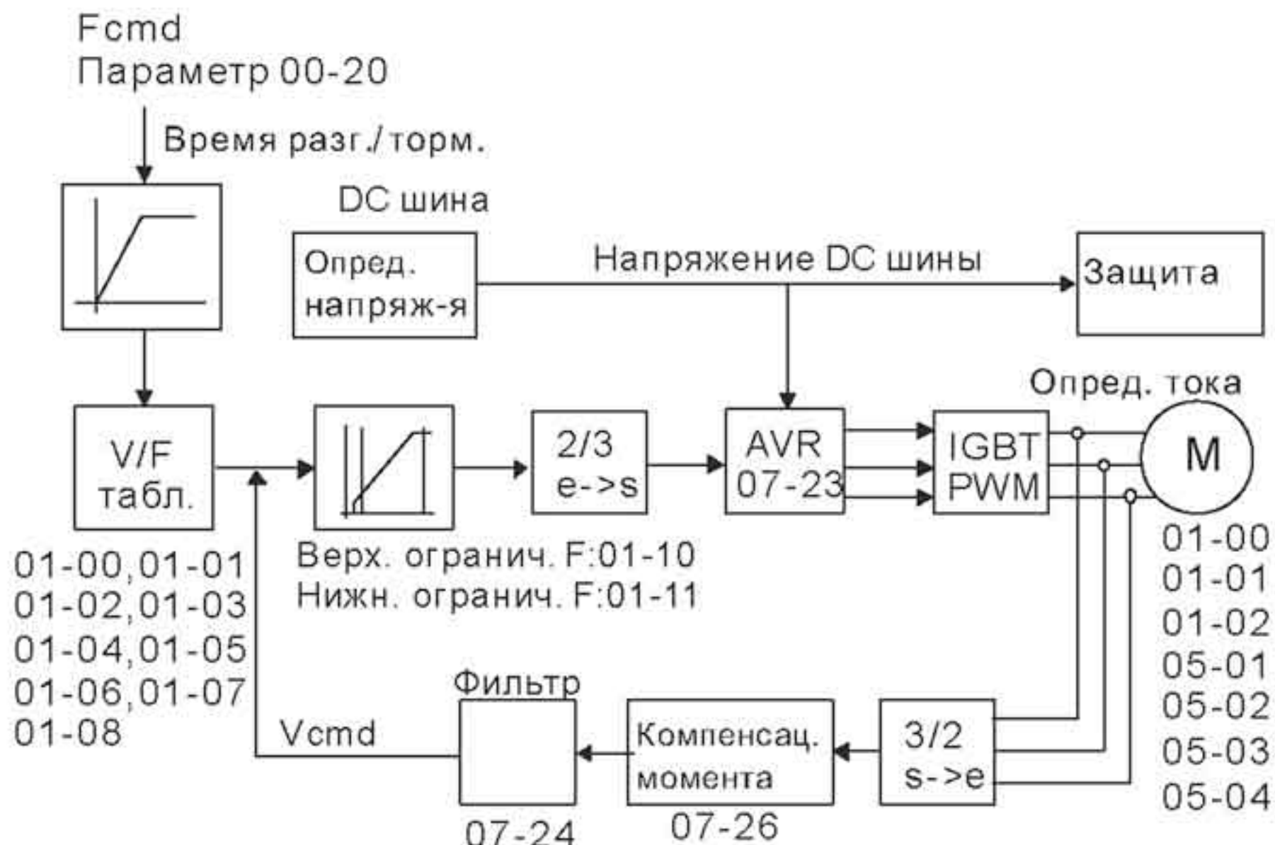
Блок-схема режима V/f управление + Энкодер (параметр 00-11 = 1).
